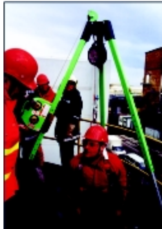
Abbildung 20: Kombination aus Rettungsgerät (Winde) und PSA gegen Absturz (Höhensicherungsgerät)
