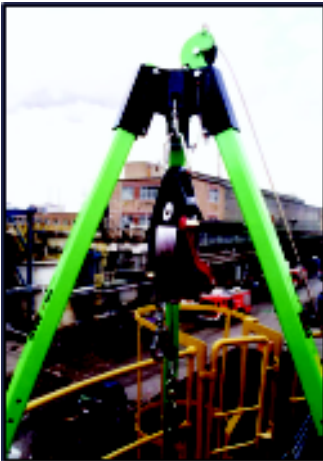
Abbildung 19: Höhensicherungsgerät mit integrierter Hubeinrichtung
