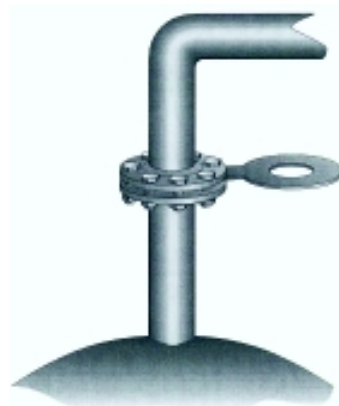
Abbildung 16: Abtrennen mittels Steckscheibe
