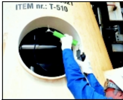
Abbildung 18: Probenahme mittels Gassammelrohr
